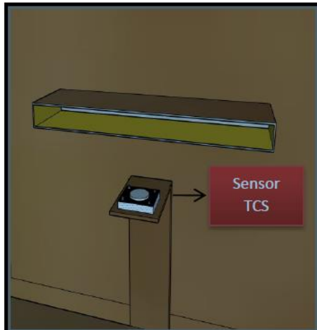
Gambar 12. Bagian Sensor Warna TCS 3200 kotak amal pintar berbasis Microcontroller nodeMCU ESP 8266
